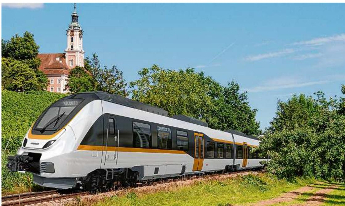
So wie hier auf dieser Bildmontage könnte ein batteriebetriebener Zug aussehen, der möglicherweise auf der Bodenseegürtelbahn fahren würde - ohne Oberleitungen. Zu sehen ist das Modell „Talent 3“, das von Bombardier entwickelt wurde und die Batterien auf dem Dach haben wird. Bilder: Bombardier/Jäckle, Montage: Jäckle
